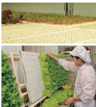
野菜工場段構成の水耕ベッド(上)と育成コントロール環境表示パネル(左)。同社では特許を取らず一切のノウハウを公開している。「活菜Mini」の若い状態で出荷するまでは10日で1サイクル、普通は20日。根付きで出荷される。
