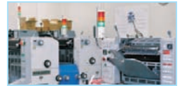
印刷機には色別の状態表示ランプがつく。 何らかの故障があると赤が点灯する。
