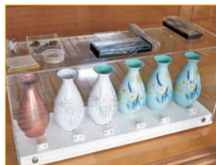
七宝焼は①銅などの地金に珪瑯を焼付け、②銀線で輪郭を植え、③その銀線の輪郭の中に色をさして焼き上げ、④最後に表面を研磨して仕上げる。
