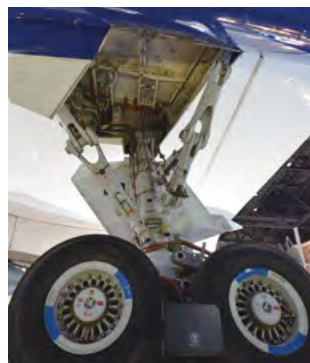
約100tの重量を支えるランディングギア。精緻なメカも間近に見られる。
