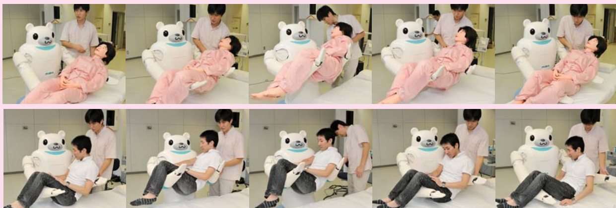
(上段) 寝ている人形を使っの介護実験。はじめにRIBAは合成音声で「お姫様だっこ開始」と話し動作に入る。介護の現場では、こうしたちょっとしたユーモアが必要だ。 (下段) 生身のヒトで実験。抱き上げる時には、安全倫理委員会の規定でサポートメンバーがまわりを取り囲む。介護士役の向井さんがRIBAの腕に触れて腕の位置修正の指示を与えていく。きめ細かなサーボモーターの静かな作動音が頼もしく感じられた。
