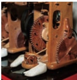
ゼンマイのエネルギーを伝える歯車は硬いカリンを縦方向で放射状に貼りわせてある。
